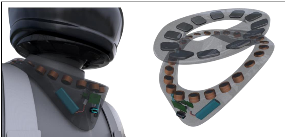
Figure 6-25 Positionnement des composants électroniques, des électro-aimants et des aimants permanents.
