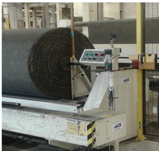
Figure 2.2 Rouleau de voile non-tissé aiguilleté.
