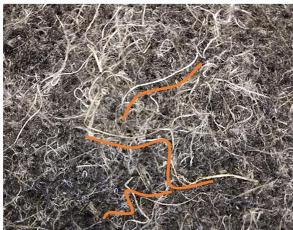
Figure 4.1 Distribution réelle des fibres de lin au sein du voile non-tissé lin-PP.
