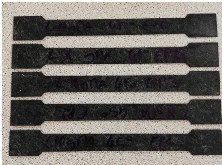
Figure 2.5 Eprouvettes de traction selon la norme ISO 527-4.
