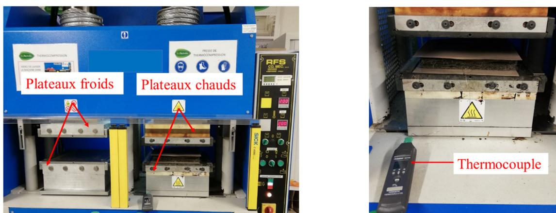
Figure 2.4 Thermo presse utilisée.
