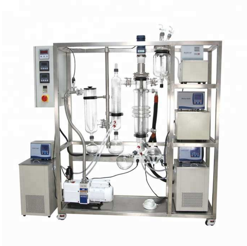
Figure 20 : Exemple d'un montage de distillation sur couche mince
