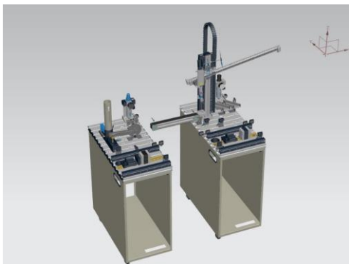
Figure 99 : Jumeau numérique de la station bouchonnage
