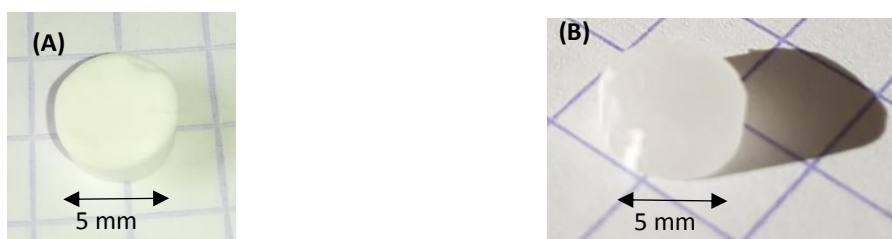
Figure II-7 : Exemples typiques (A) d'un monolithe de silice, (B) d'un ionogel constitué d'une matrice de silice imprégnée par un liquide ionique.
