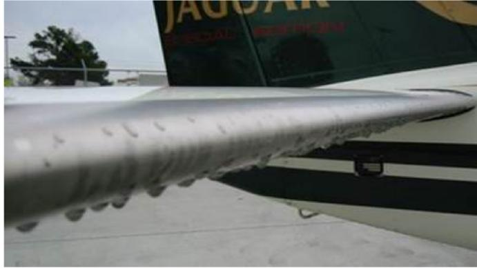
FIGURE 1.3 – Injection de fluide dégivrant sur le bord d'attaque d'une aile d'avion
