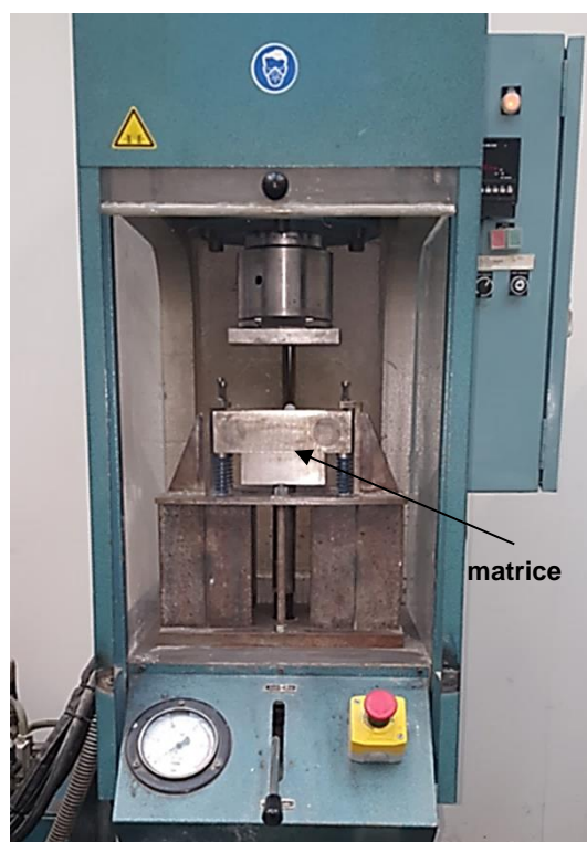
Figure V-5 : presse hydraulique utilisée pour la mise en forme des matériaux MA/Réf, MACBR800-1/Réf et MACBR800-1/multicouche
