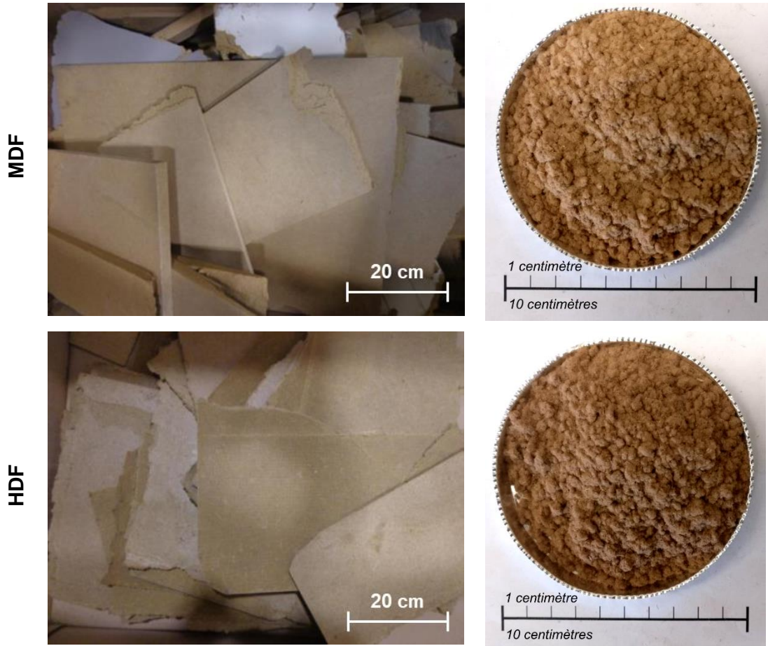
Figure II-7 : aspect physique des DEA ; gauche : avant broyage et droite : après broyage
