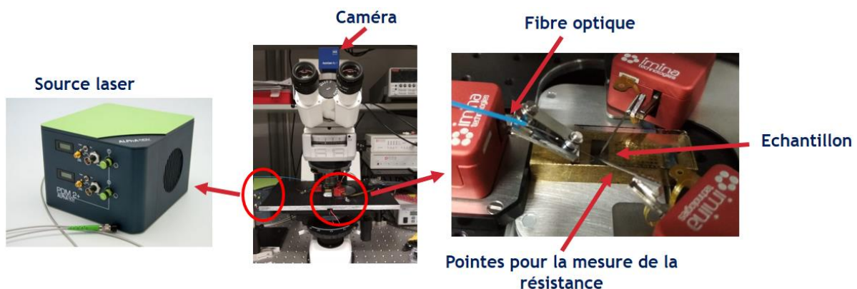
Figure 73 : Dispositif d'irradiation optique en utilisant des diodes laser infrarouge.
