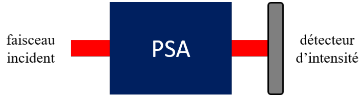
FIGURE 1.10 – Polarimètre de Stokes ; PSA : Polarization State Analyzer.
