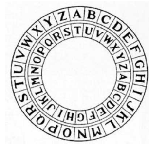
FIGURE 1.1 – Disque facilitant le chiffrement-déchiffrement de César.
