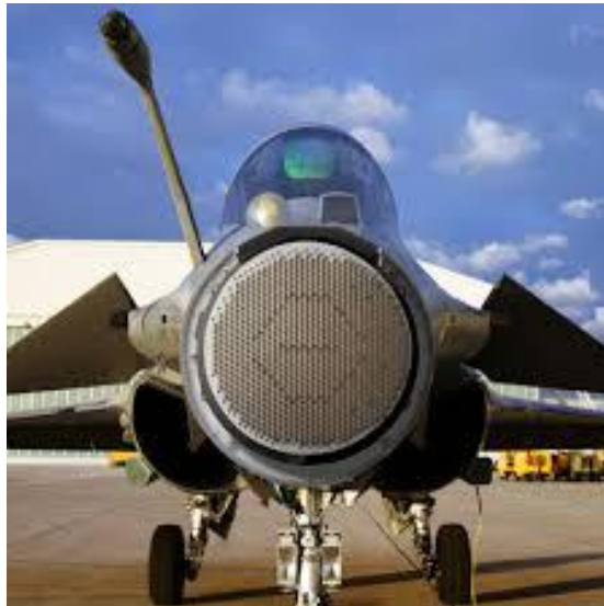
Figure I-27 : Radar à balayage électronique actif RBE2-AESA de Thales monté dans le nez d'un avion de chasse Rafale [18].
