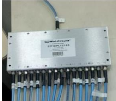
Fig.1. 8: Diviseur de puissance 1 voie vers 16 (Mini-Circuits, ZC16PD-2185)
