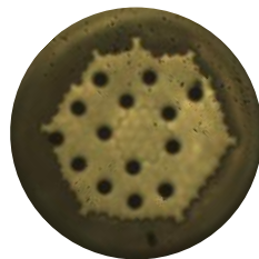
Figure III-6 – Image au microscope de la face d'une FA-LPF présentant un \Delta n de +4.10^{-5} .
