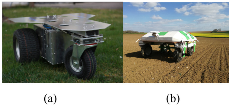
FIGURE I.4 – Exemple de robot (a) tricycle, (b) type voiture.
