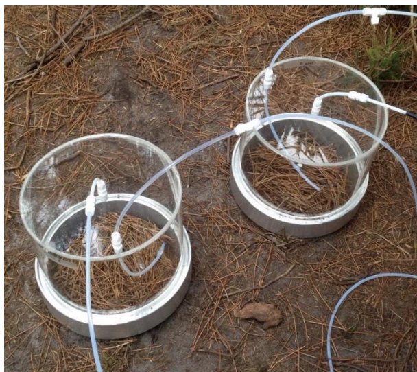
Figure 11 – Système d’enfermement dynamique sous forme de cloche utilisé pour le prélèvement de COVB in situ dans les Landes (Chapitre V).
