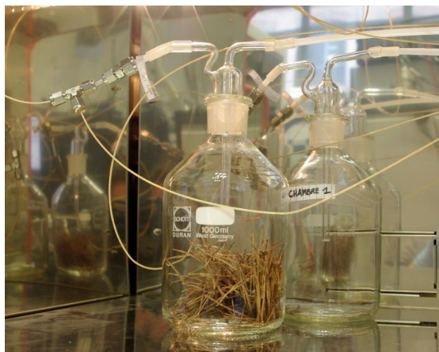
Figure 7 – Système d’enfermement dynamique sous forme de bocaux utilisés pour le prélèvement in vitro des COVB de la litière provenant des litterbags.
