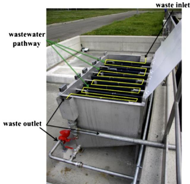
Figure 38 : Bac d'exposition de dreissènes de la station pilote de Milan-Nosedo (Italie), la ligne jaune représente la circulation de l'effluent (Binelli *et al.*, 2014)
