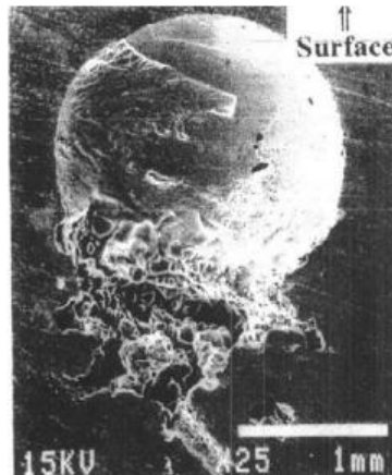
Figure 1: Exemple de porosité dû à l'emprisonnement de gaz [CAMII]
