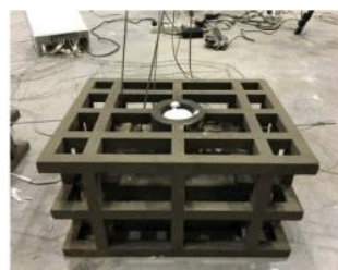
Figure 1.2-4: Structure de moule en coque imprimée [SHA17]
