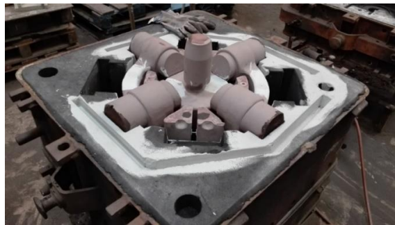
Figure 3.2-1 : Photographie d'un moule ouvert chez la fonderie Vignon
