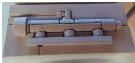
Figure 3.3-8: Photographie d'une partie de moule dont les noyaux sont solidaires
