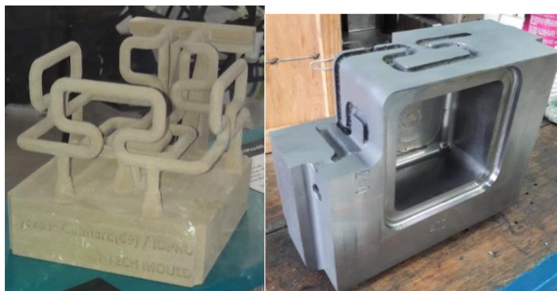
Figure 1.2-8: Outillage de grande dimension avec du conformal cooling réalisé par le CTIF [MAC17]
