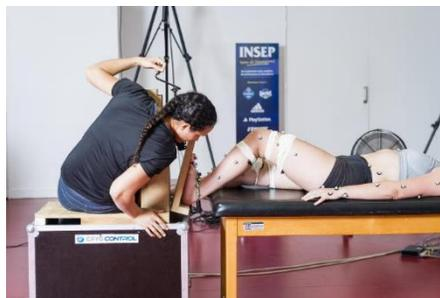
Figure 25 : photo de l'expérimentation pour le test  $DF_{GE_{max}}$ . La flexion de cheville augmente grâce à un système avec un cric tenu dans la main gauche de l'opérateur et fixé entre les planches. L'opérateur vérifie que le talon ne colle pas de la planche lorsque la flexion de cheville augmente.
