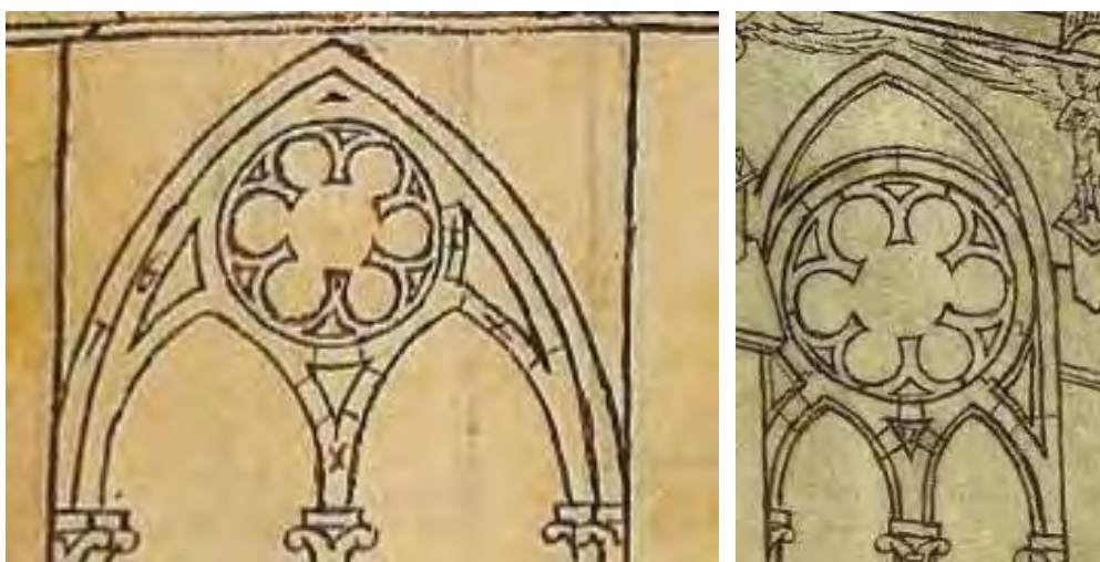
Fig. 105. Reims : rose et calpinage de la nef (fol. 31v) et celui de le chapelle rayonnante du chœur (fol.30v).
