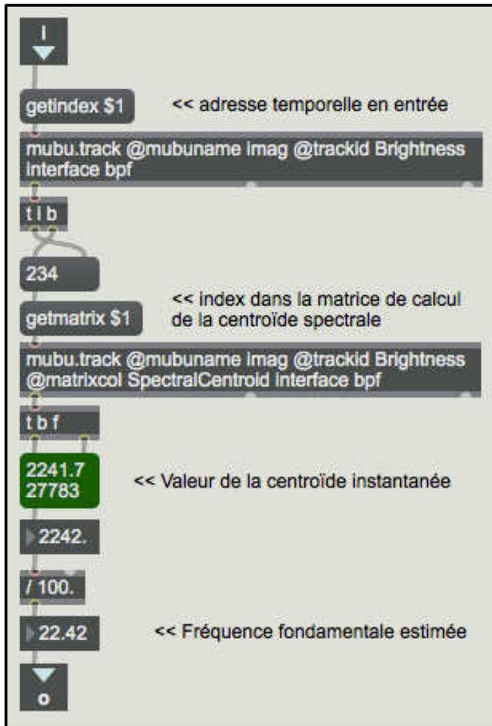
Figure IV.8.1 Sous-module d'évaluation de la centroïde spectrale instantanée
