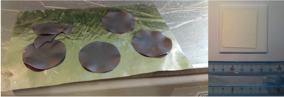
Figure 4.2. Echantillons de bandes minces de B 2 Co sans préfrittage présentant l'effet « chips » (gauche), de BT frittées avec un cycle incluant un préfrittage et non déformées (droite)
