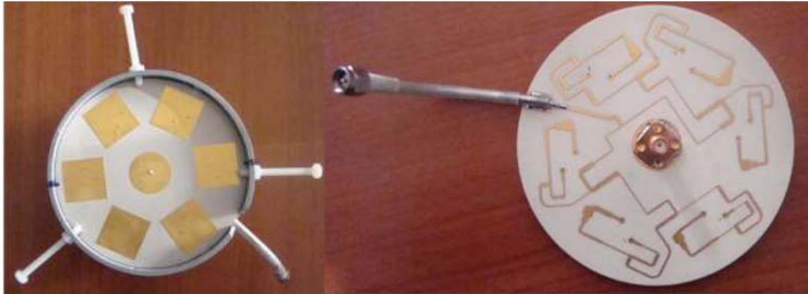
Figure 54 : réseau d'antennes patches réalisé (à gauche) et son circuit de distribution (à droite)
