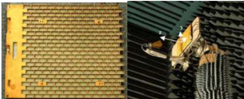
Figure 21 : panneau en réflexion (à gauche), l'antenne ERASP en cours de test (à droite) [17]
