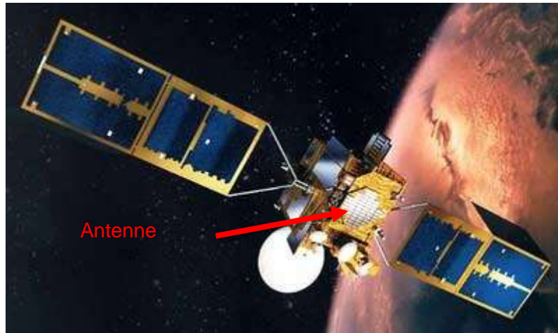
Figure 10 : le satellite STENTOR et son antenne AESA [7]
