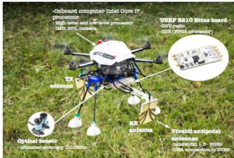
Figure I.20: Système SAR aéroporté pour la détection des mines [54].
