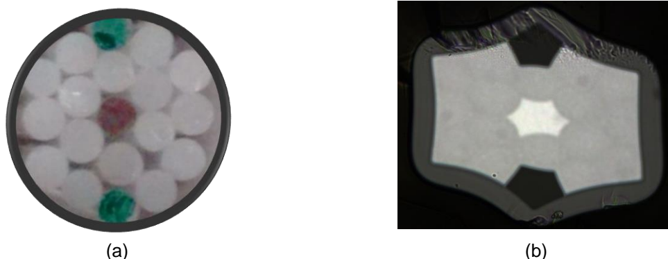
Figure II.8 : (a) L'assemblage (ou le stack) des cannes formant la préforme de la future fibre PM dopée thulium : en rouge la canne dopée Tm^{3+}/Al^{3+} , en blanc les cannes dopées Al^{3+} et en vert les plots de bore. (b) Une image microscopique de la fibre étirée montrant la structure de la fibre.
