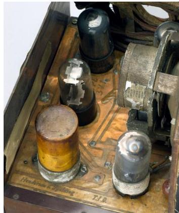
Figure I-2: Première radio utilisant un PCB en 1942 [I.6]
