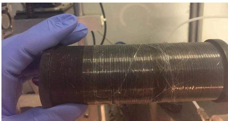
Figure II.11. Fibres crues obtenues par filage en fondu sur une bobine récupératrice
