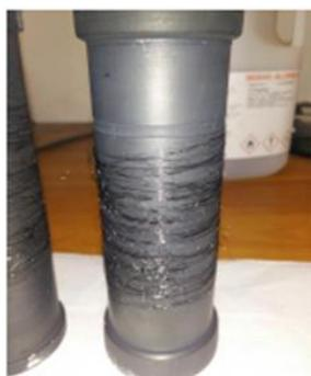
Figure III.27. Fibres céramiques SiBCN sur bobine de graphite issues de la réticulation puis de la pyrolyse à 1000 °C sous azote de **BmCPS5.3MA**
