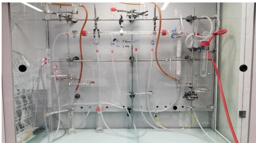
Figure II.1. Rampe vide/argon utilisée pour les synthèses
