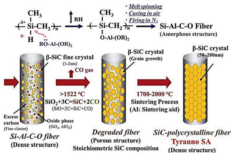
Figure I.16. Procédé de production de la troisième génération de fibres de carbure de silicium Tyranno SA<sup>91</sup>
