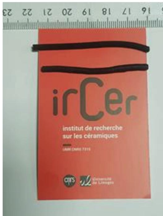
Figure IV.39. Capillaires Si-B-C-N après pyrolyse de fils crus de **PSZB3,75MA1,25I**
