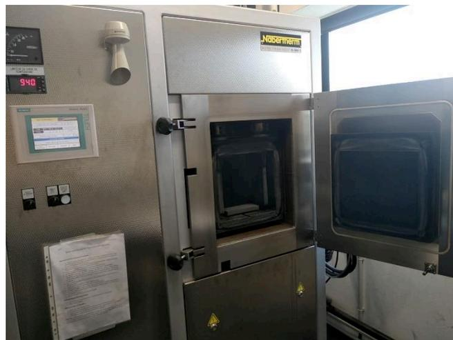
Figure II.14. Four Nabertherm VHT-GR permettant des traitements thermiques jusqu'à 2100 °C
