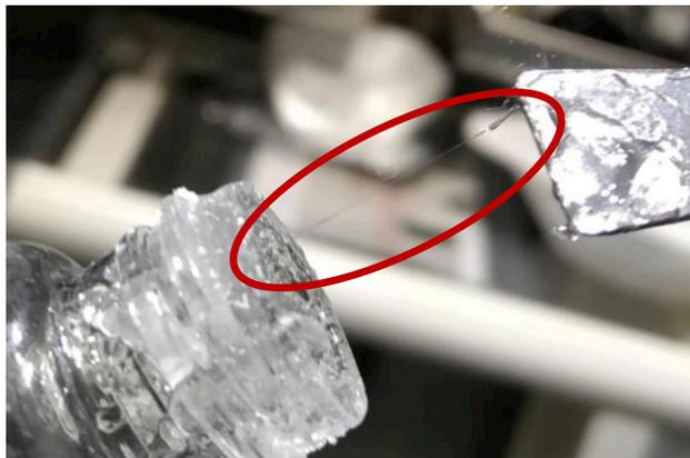
Figure V.9. Élaboration de fibres crues à partir du **polymère PSZB3,75-BDMA** thermolysé 2 heures sous vide à 100 °C
