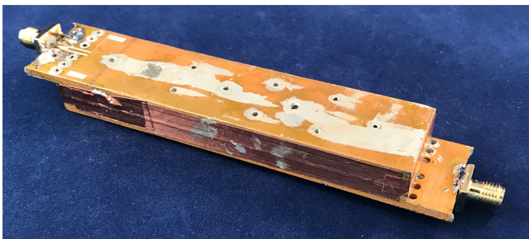
Figure 113 : Photographie du filtre 10 pôles 4 zéros obtenu après les mesures correctives.
