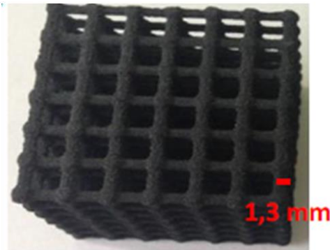
Figure 3.36 : Exemple d'une structure treillis imprimée, avec des barreaux de 1,3 mm.
