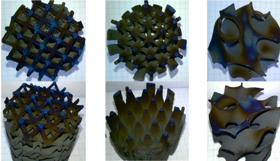
Figure 4.15 : Structures après les essais. De gauche à droite : « Mousse organisée », « Cônes » et « Gyroïde ».
