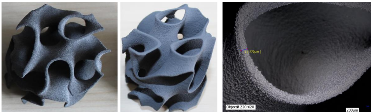
Figure 3.39 : Structure « Gyroïde », de diamètre 5 cm, avant renforcement par CVD/CVI (à gauche) et après (au centre). Image de la structure après renforcement prise au microscope optique (à droite) avec précision sur la valeur de l'épaisseur de la paroi.
