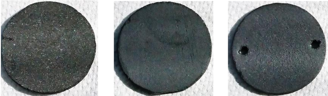
Figure 3.18 : Echantillons fabriqués. A gauche, sans renforcement par CVD/CVI. Au centre, avec renforcement par CVD/CVI et où l'anse support a été retirée après polissage. A droite, avec renforcement par CVD/CVI et présence des deux trous.
