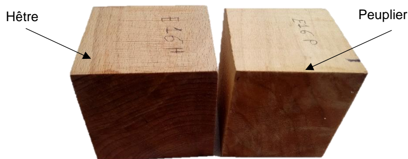
Figure 44 : Échantillons pour essais de diffusion transversale
