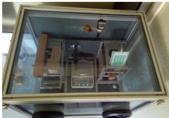
Figure 51 : Enceinte climatique de régulation d'humidité initiale
