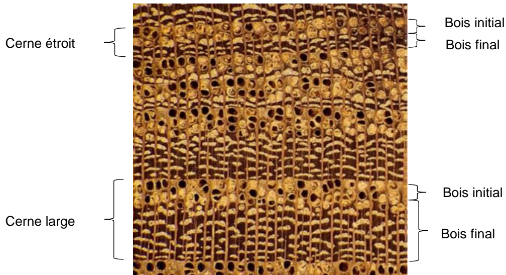
Figure 11 : Coupe transversale d'orme, avec présence de différentes largeurs de cernes (Trouy, 2016)
