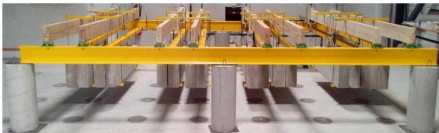
Figure 113 : Banc de flexion 4 points en intérieur
