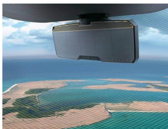
(b) Radar Searchmaster ® qui se déploie sous l'aéronef.
