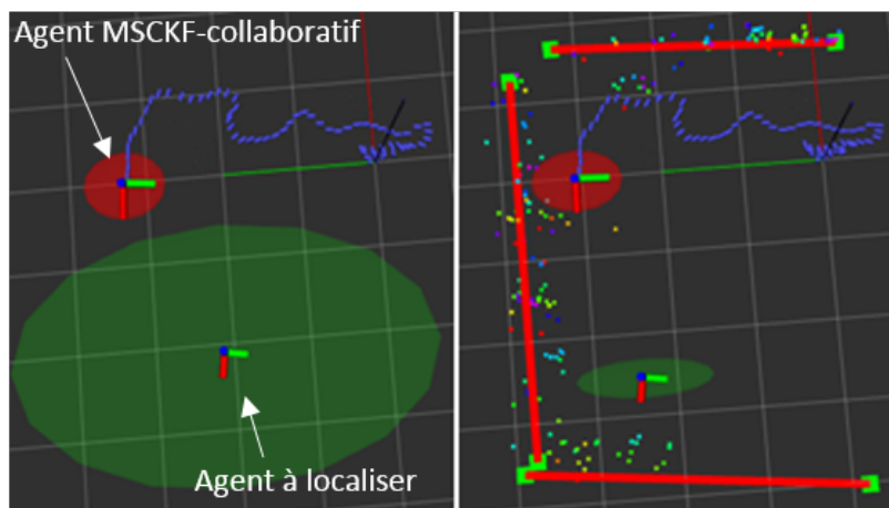
FIGURE 3.21 – Estimation de la transformation entre robots avec covariance correspondante (ellipsoïde vert ). Avec ( droite ) et sans ( gauche ) prise en compte des contraintes. Les images sont données au même moment dans l'évolution.
