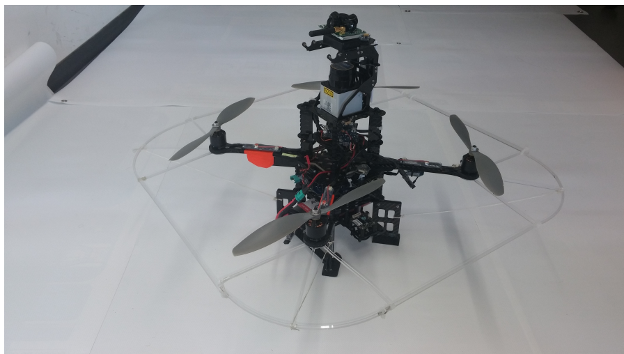
FIGURE 2.17 – Le drone AscTec Pelican utilisé dans les expérimentations.
