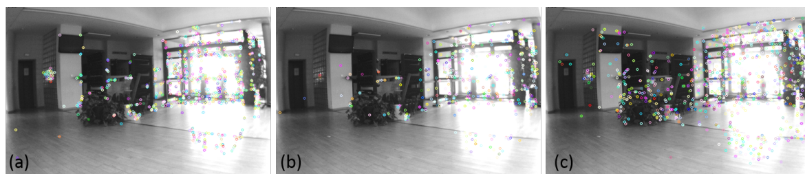
FIGURE 1.4 – Exemple de détection de points d'intérêt, (a) SIFT, (b) ORB, (c) BRISK.
