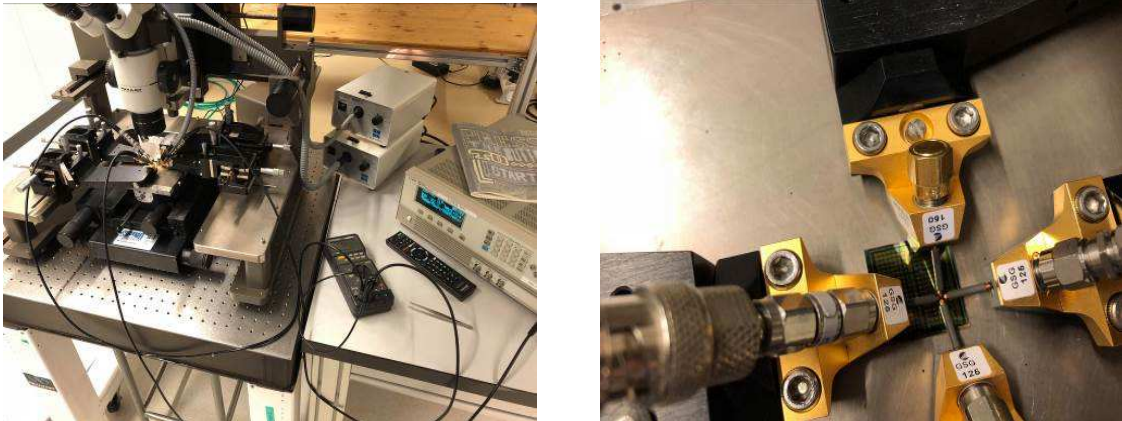
Figure III-23 : Les photographies du banc de mesure utilisé pour caractériser le commutateur réalisé.
