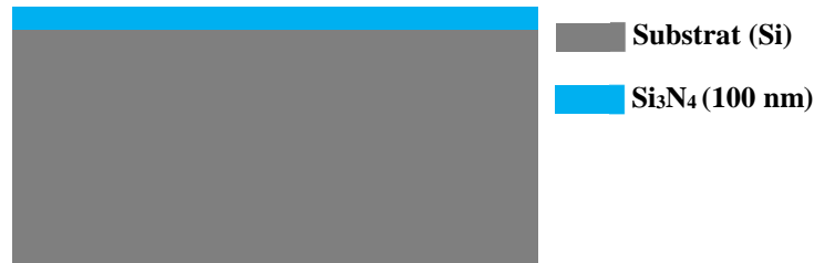
Figure III-1 : La coupe transversale de la structure après le dépôt de la couche de passivation de \text{Si}_3\text{N}_4 .
