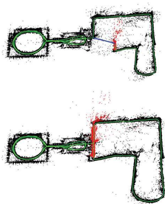
Figure 1.3. – (haut) Détection de la fermeture de boucle en bleu (bas) Carte corrigée. La carte est représentée par un nuage de points en noir. La trajectoire estimée du robot est en vert et les observations à cet instant sont en rouge [Mur-Artal et al., 2015].
