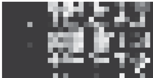
Figure 3.2. – Représentation du problème sous forme de carte de couts. La matrice de couts C est représentée sous la forme d’une grille où l’intensité dépend de la similitude entre les nœuds. Les lignes sont les nœuds de la carte terrestre et les colonnes sont les nœuds de la carte aérienne.
