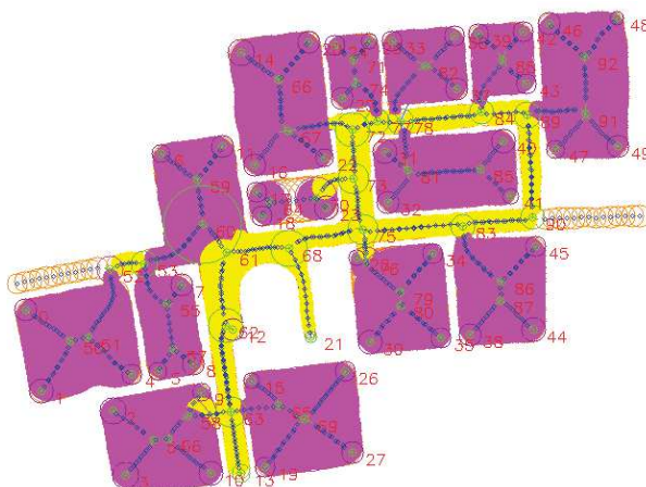
Figure 2.11. – Données sémantiques portées par la carte hybride. Les régions en violet correspondent aux salles, et celles en jaune aux couloirs.
