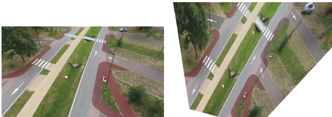
Figure 4.9. – Transformation en orthoimage. (gauche) Image acquise par le drone, (droite) Orthoimage correspondante.
