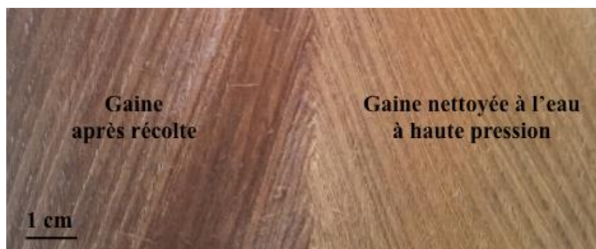
Figure 61 : Aperçu de la gaine avant et après le nettoyage à l'eau à haute pression
