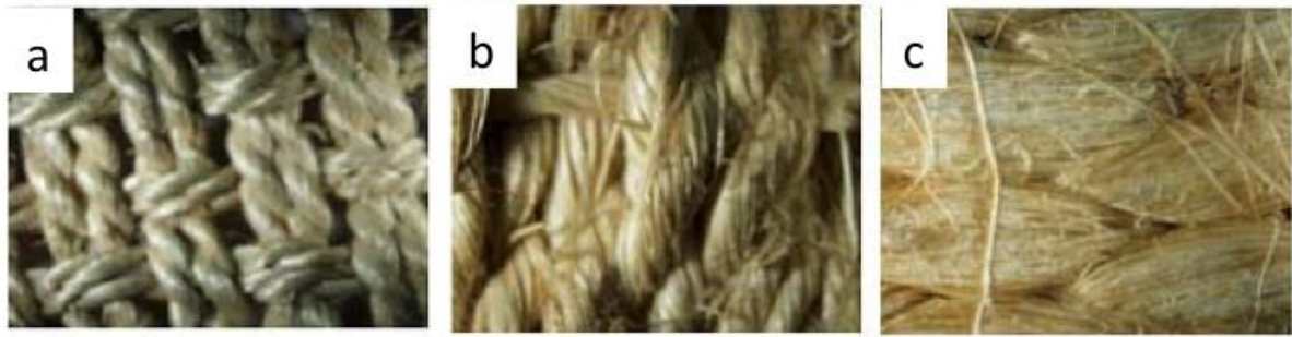
Figure 32 : Architectures des tissus sisal : a-taffetas, b-sergé, c-mat (Pothen et al. , 2002) dans (Li et al. , 2009)
