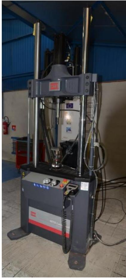
Figure 4-8. Machine d'essai hydraulique universelle MTS (MTS System Corp. MN, États-Unis)
