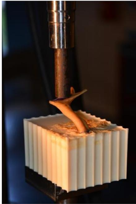
*Figure 4-6. Mis en place des mandibules dans l'encastrement de résine FAST CAST F180.*
