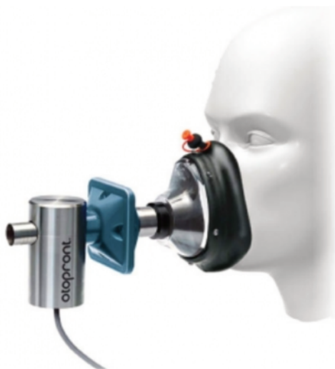
Figure 1.11. Système de rhinomanométrie antérieure active. Pendant le test, le patient respire avec une fosse nasale, l'autre étant volontairement obstruée. Grâce à un capteur de pression et un débitmètre, il est possible de calculer la différence de pression entre l'entrée de la fosse nasale et le rhinopharynx, donc de mesurer la perte de charge \Delta P .
