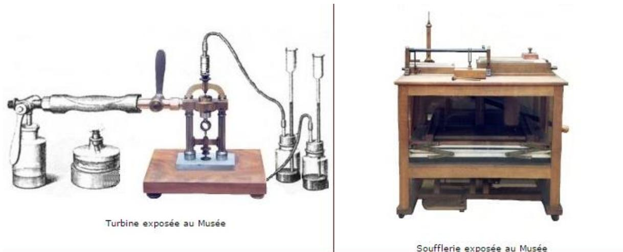
**Fig. 8. Appareils utilisés par Foucault pour permettre la rotation du miroir tournant**
