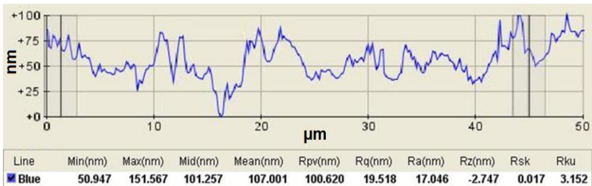
Figure 7 : Mesure AFM du profil de rugosité d'un échantillon de cuivre.
