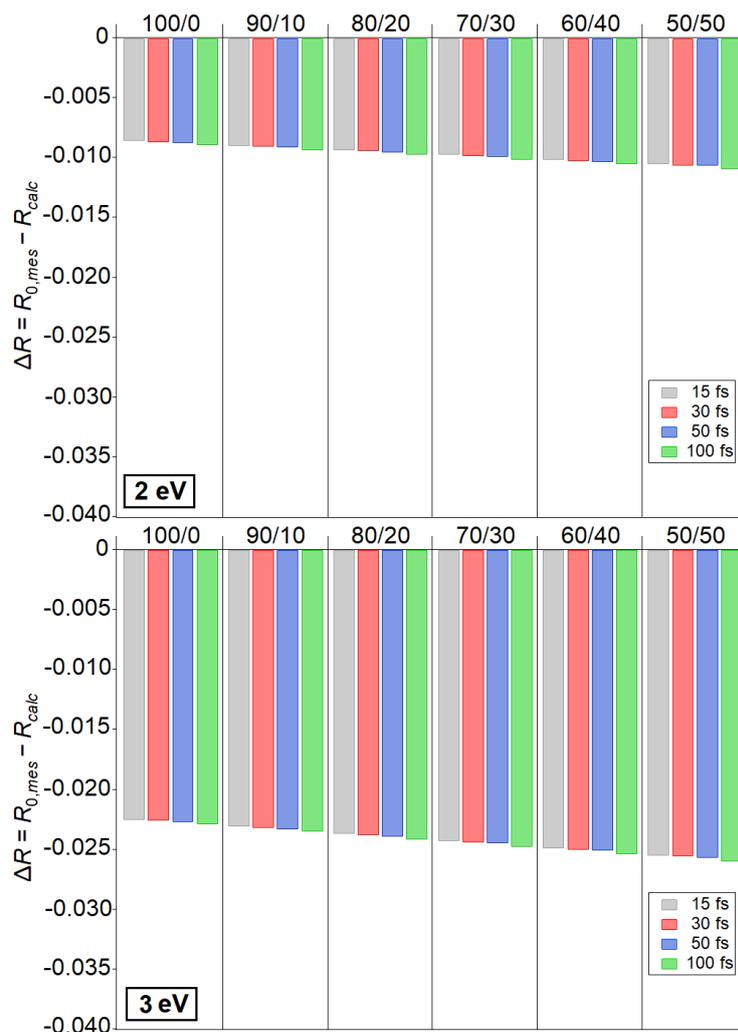
Figure 19 : Evolution de la réflectivité (par rapport à la réflectivité mesurée au repos  $R_{0,mes}=0,686$ ) calculée à la fin de l'impulsion pour deux températures de la population électronique thermalisée ( $T_e = 2 \text{ eV}$ , haut; et  $T_e = 3 \text{ eV}$ , bas) et pour différentes répartitions entre la population électronique non-thermalisée et la population thermalisée (de 100/0 à 50/50).
