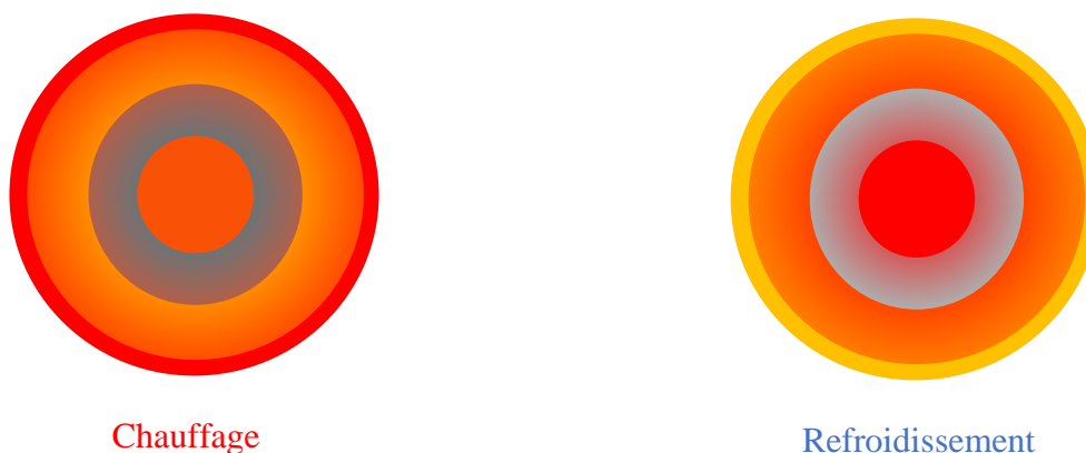
Figure 49 Représentation de la température au cœur du porte échantillon pendant un cycle de chauffage et de refroidissement
