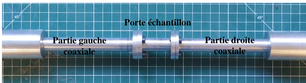
Figure 81 Photo de la nouvelle cellule de mesure THT en aluminium.
