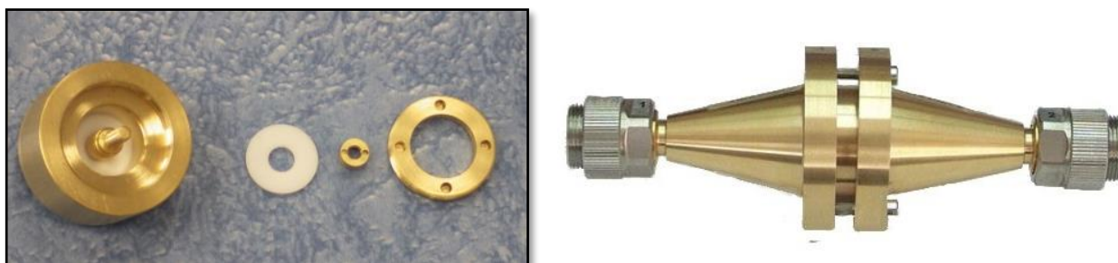
Figure 25 Images de la cellule coaxiale 13mm et de son porte échantillon de 12mm de long
