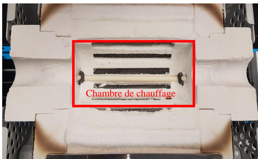
Figure 78 Zone de chauffage du four tubulaire
