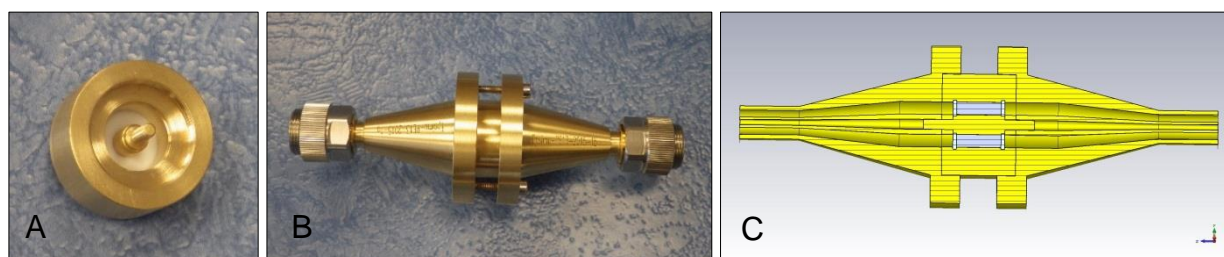
Figure 6 A : Photo de la zone de confinement de l'échantillon (Porte échantillon). B : Photo de la cellule 13mm assemblée avec les connecteurs PC7. C : Coupe de la cellule 13mm dans l'environnement de simulation CST Microwave Studio.
