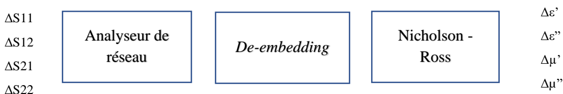
Figure 31 Étapes de mesures de permittivité et de perméabilité à partir des paramètres S
