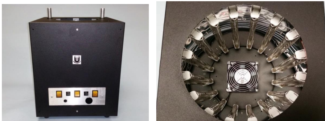
Figure II-36 : Réacteur Rayonet utilisé pendant des réactions de photopolymérisation
