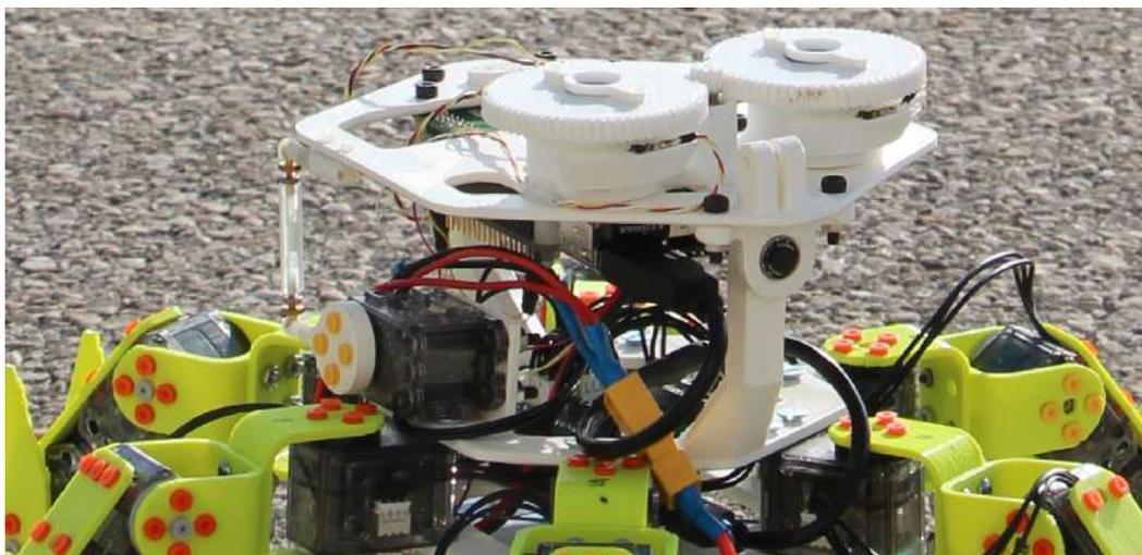
FIGURE 1.13 – Photographie de la tête du robot Hexabot. Cette tête est notamment articulée par un système de bielle (à gauche) mise en mouvement par un servomoteur XL-320 (Dynamixel). On distingue également sur le plateau le compas céleste utilisé pour la détection du cap à partir de la lumière céleste polarisée, et sous le plateau la carte Raspberry Pi 2B utilisée pour contrôler l'ensemble du robot.
