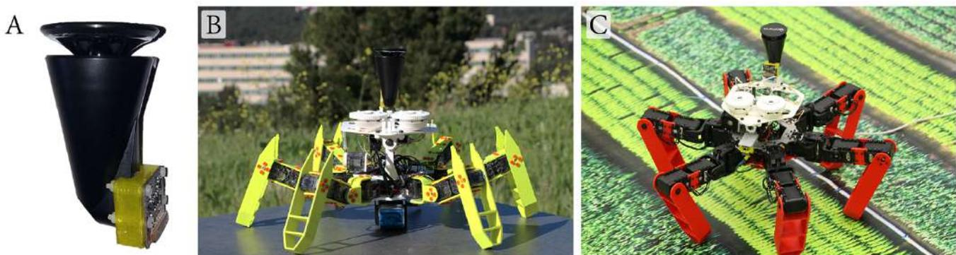
FIGURE M.1 – La vision panoramique embarquée. **A** Miroir panoramique GoPano monté sur la caméra Pi NoIR. **B** Hexabot équipé de la caméra panoramique. **C** AntBot équipé de la caméra panoramique.
