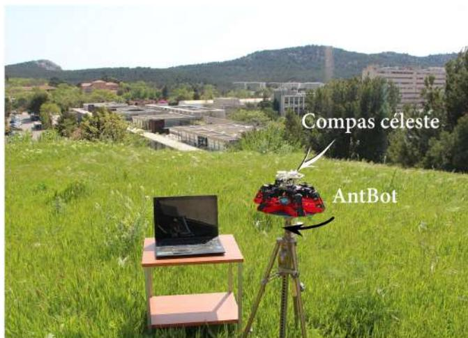
FIGURE 2.20 – Contexte expérimental pour l'évaluation des performances du compas céleste, embarqué sur le robot AntBot. L'ordinateur est uniquement utilisé pour contrôler l'expérience (communication avec AntBot via un réseau privé WiFi). Le robot était monté sur un plateau tournant par pas de  $10^\circ$ .
