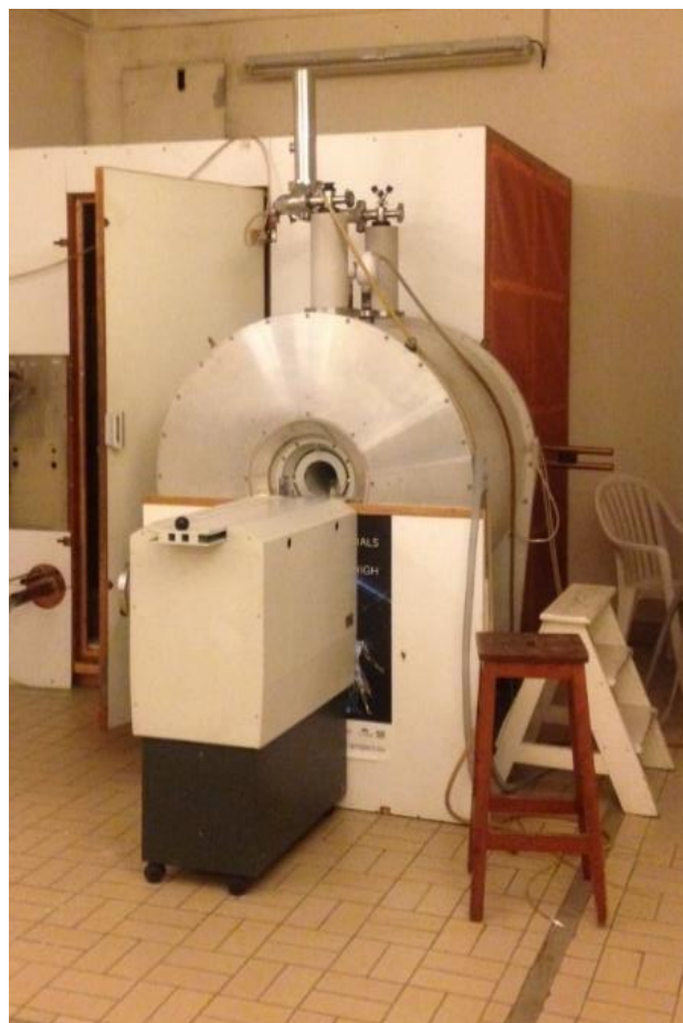
Figure 24 Aimant Biospec 4,7T utilisé lors des examens cardiaques.
