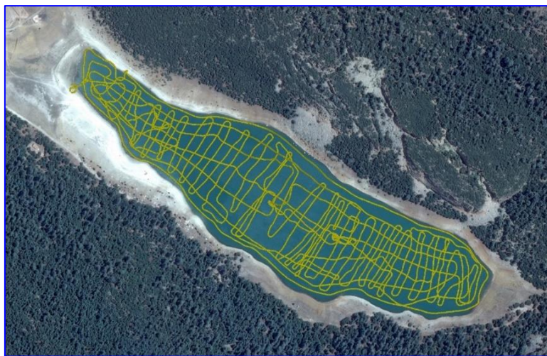
Fig. CH II. 3 : Schéma d'acquisition des données bathymétriques du lac Azigza (avril 2015).
