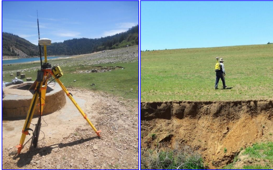
Fig. CH II. 2 : Positionnement de la base fixe du DGPS-RTK et déplacement de l'unité mobile (avril 2015).
