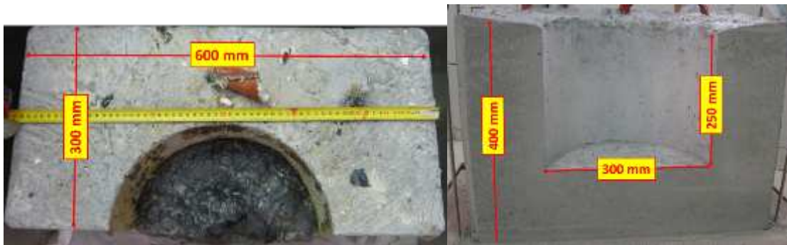
Figure 3-5: Gauche : Vue de dessus d'une section d'essai VULCANO après remplissage par le corium. Droite : Vue de face de la section d'essai avant le remplissage
