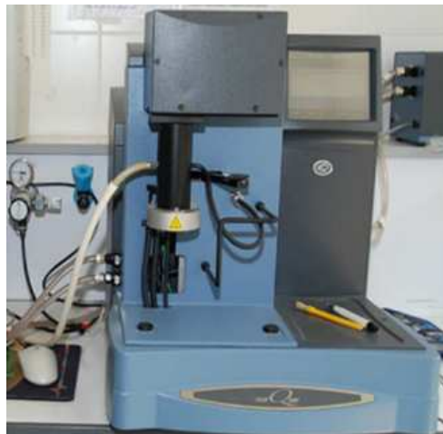
Figure 3-15: ATG-500 utilisé pour l'évaluation des pertes de masses des échantillons en fonction de la température
