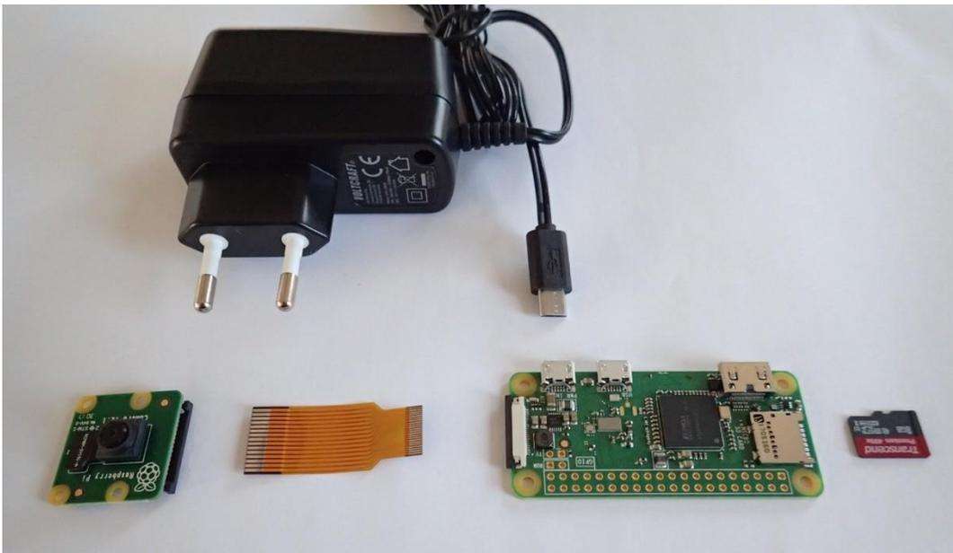
Figure 2-20 *Ensemble des éléments nécessaires à la prise de vidéo. Une Raspberry Pi zero (à droite) peut être utilisée avec un module caméra (à gauche). Une fois le système installé sur la carte micro SD la communication avec la Raspberry peut se faire par Wi-Fi.*
