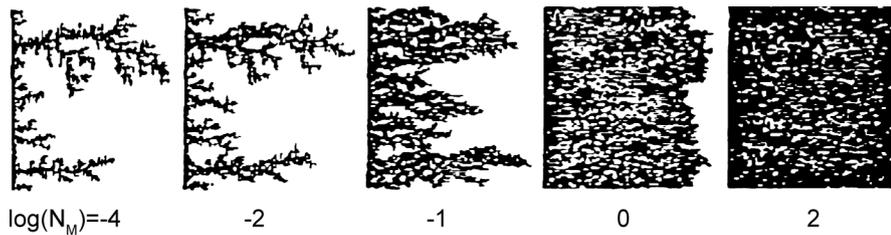
**Figure 3.14:** Simulation de l'écoulement de deux fluides pour des  $N_M$  différents et  $N_{Ca} = 1$  (Adapté de Lenormand *et al.*, 1988).
