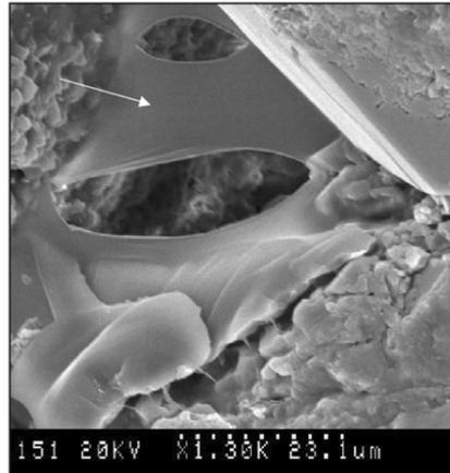
**Figure 5.1:** Photographie au microscope à balayage électronique d'une lamelle à l'entrée d'un pore (Kutay et Schramm, 2004). Les déchirures de la lamelle proviennent de la préparation de l'échantillon.
