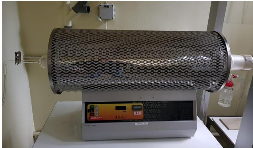
*Figure II.3* Four Carbolite utilisé pour les recuits thermiques des échantillons
