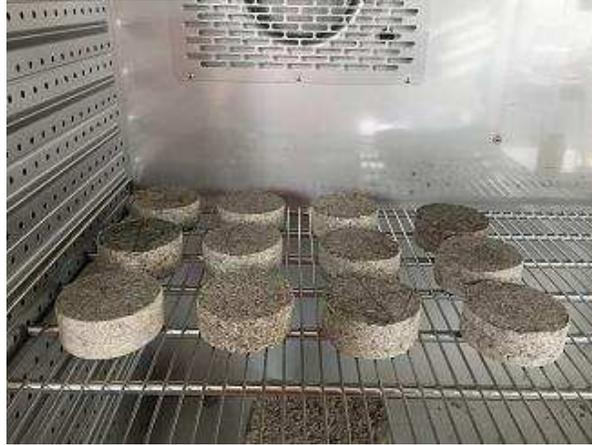
Figure III.20: Echantillons utilisés pour la mesure de l'absorption acoustique.
