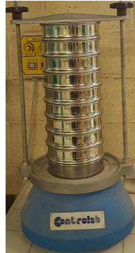
Figure II.10: Tamiseuse à vibration Controlab.
