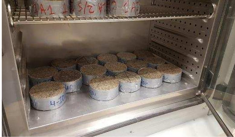
Figure IV.3: Photographie des échantillons utilisés pour la mesure du MBV.
