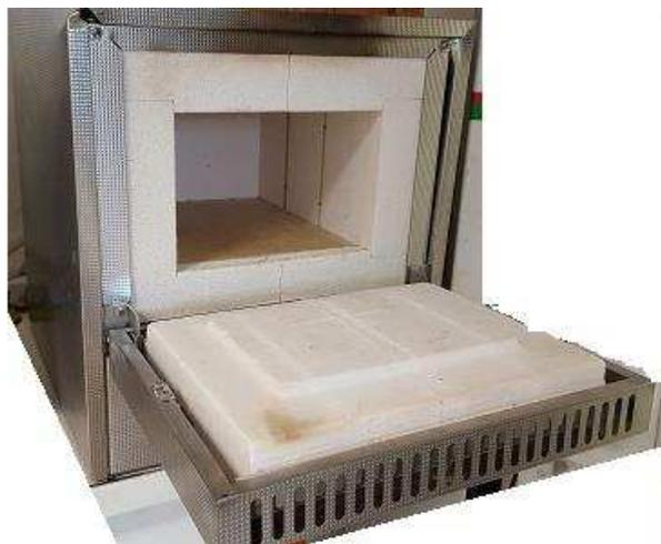
Figure II.13: Four à moufle de modèle KL 05/11 utilisé pour calciner l'échantillon.
