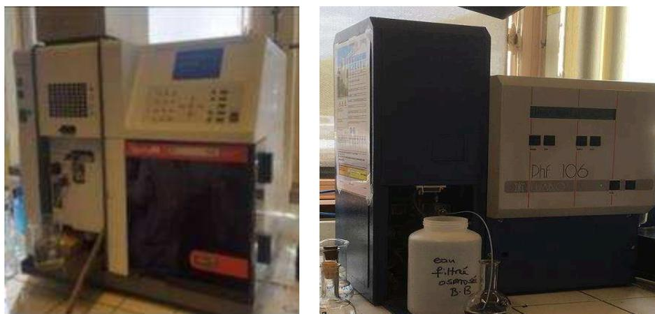
Figure II.14: Spectrophotomètre d'absorption et d'émission atomique.
