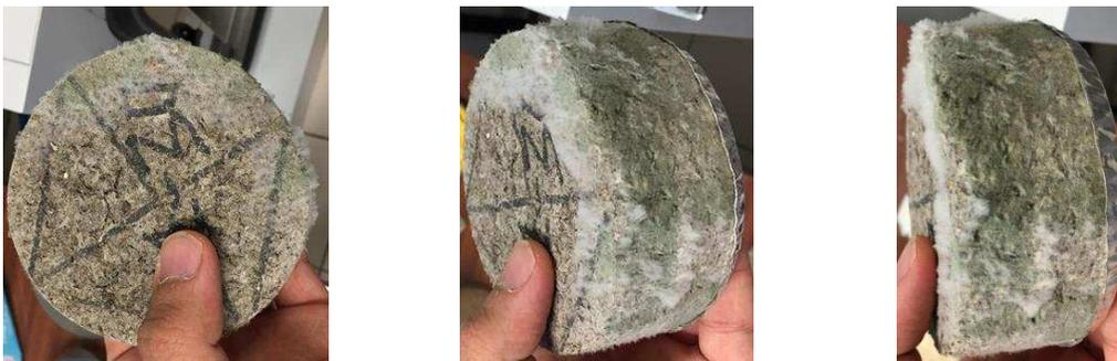
Figure IV.10: Echantillons du composite ayant un rapport massique A/PB = 0,3 qui sont infectés par l'attaque microbienne à 92% HR.
