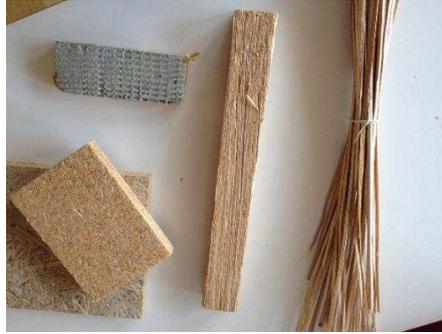
Figure I.8: Panneaux de cattaills et un liant magnésite [56].
