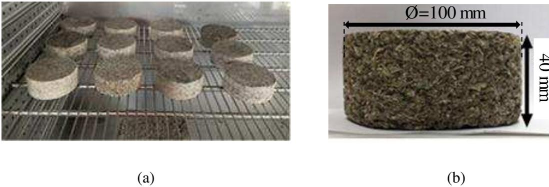
Figure IV.2: (a) Echantillons utilisés pour la mesure de l'isotherme de sorption ; (b) Dimensions de l'échantillon.
