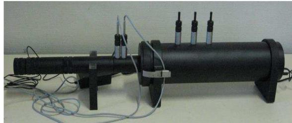
Figure III.16 : (a) Tube de Kundt pour les basses fréquences ; (b) Pour les hautes fréquences.
