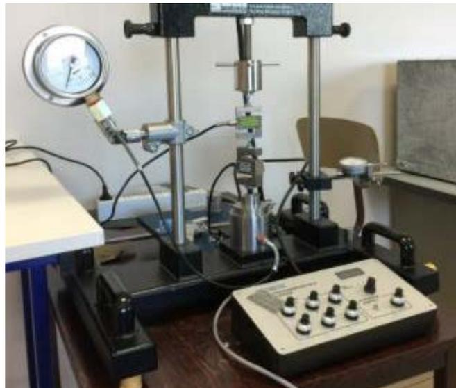
Figure 35 Montage complet sur la machine d'essai flambant GUNT WP 120 Hamburg
