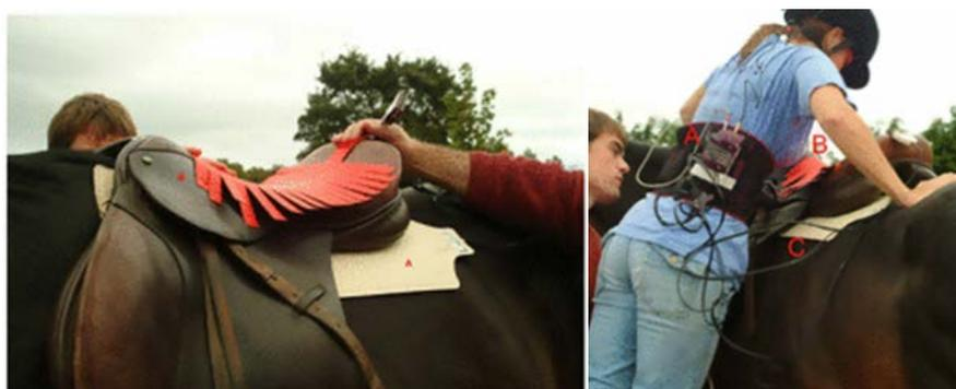
Photo de gauche, une nappe de selle orange adaptée d'un outil pour selle de vélo, capteur de pression. Photo de droite, A ; système de communication, B ; capteur orange sur la selle, C ; tapis Pliance Novel sous la selle capteur de pression.
