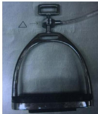
Figure 65 Etrier et jauge soudée (Delta) Femke, 2012
