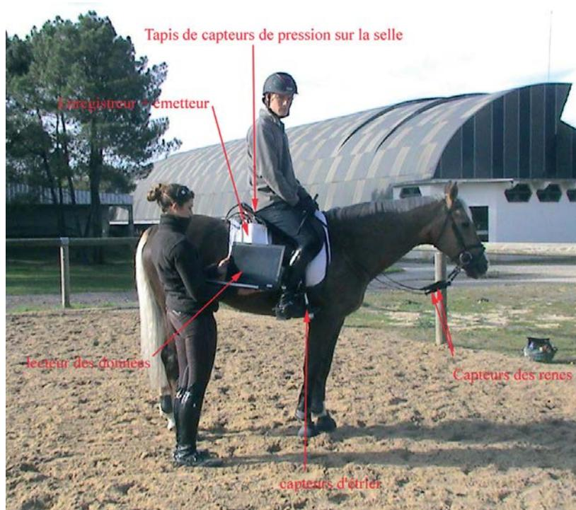
Sur les rênes près de la bouche du cheval ; capteurs de rêne, sous les pieds du cavaliers ; capteur d'étrier, sur la selle un tapis capteur de pression, en arrière de la selle ; un émetteur, et un ordinateur pour récupérer les data.
