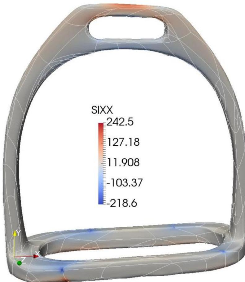
Figure 31 : Illustration de la contrainte sur un étrier (Mpa)
