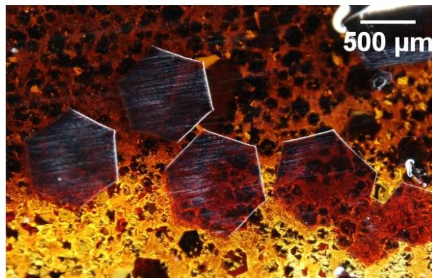
FIGURE 3.16 – Photo au microscope optique de cristaux de magnétoplumbite  $\text{PbFe}_{12}\text{O}_{19}$  dans la glaçure préparée avec  $\text{Fe}(\text{acac})_3$  cuite à 1023 °C et refroidie lentement.
