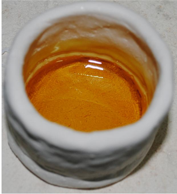
FIGURE 4.11 – Photo, après cuisson (fusion à 1000 °C suivie d’une trempe), de la fritte binaire préparée dans un creuset en terre cuite.
