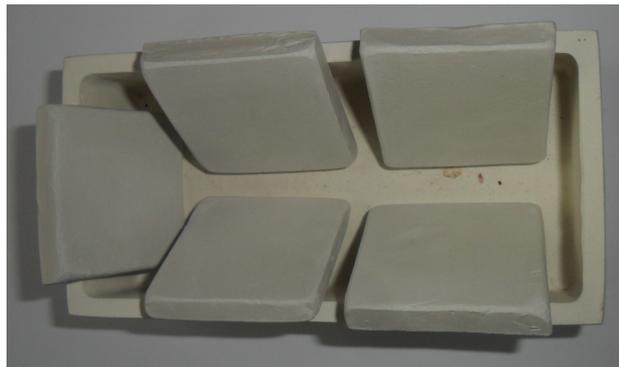
FIGURE 4.12 – Supports argileux (3 cm × 3 cm) préparés à la Cité de la Céramique de Sèvres.
