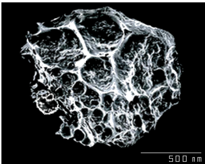
Figure 7: Taille de pores polydispense des charbons actifs. Image de microscopie électronique à balayage d'un charbon actif. [23]
