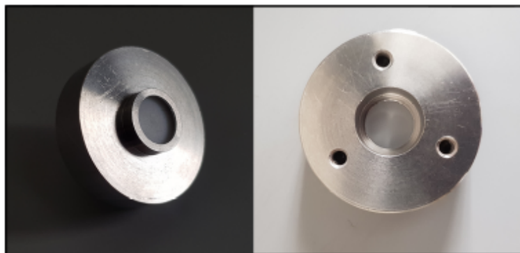
Figure 21: Photographie du porte-échantillon pour solides. (diamètre de la coupelle : 16 mm).
